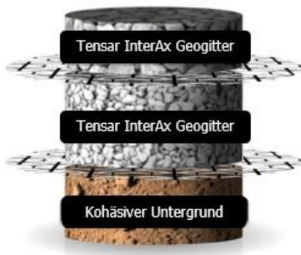
Abbildung 3 – MSL mit Tensar Geogitter
