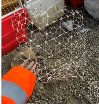
Abbildung 6: Ausgebautes Geogitter
