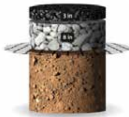
Sección estabilizada con InterAx
