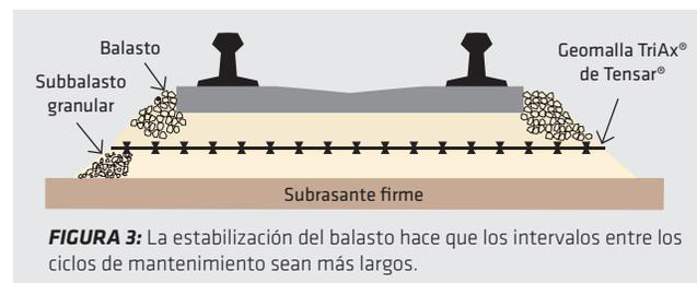
FIGURA 3: La estabilización del balasto hace que los intervalos entre los ciclos de mantenimiento sean más largos.
