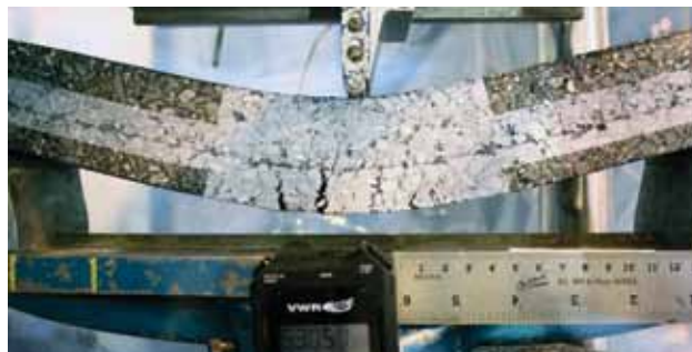
GlasGrid TF otorga una adhesión superior en la sección transversal del pavimento minimizando las grietas y maximizando el desempeño.
