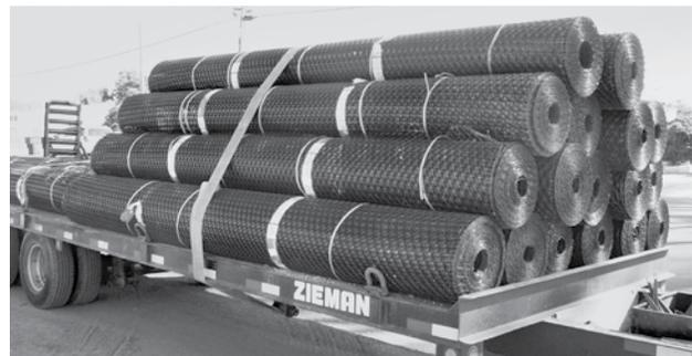
IMAGEN 1: Almacenamiento de los rollos de geomalla TriAx Tensar (horizontalmente).
